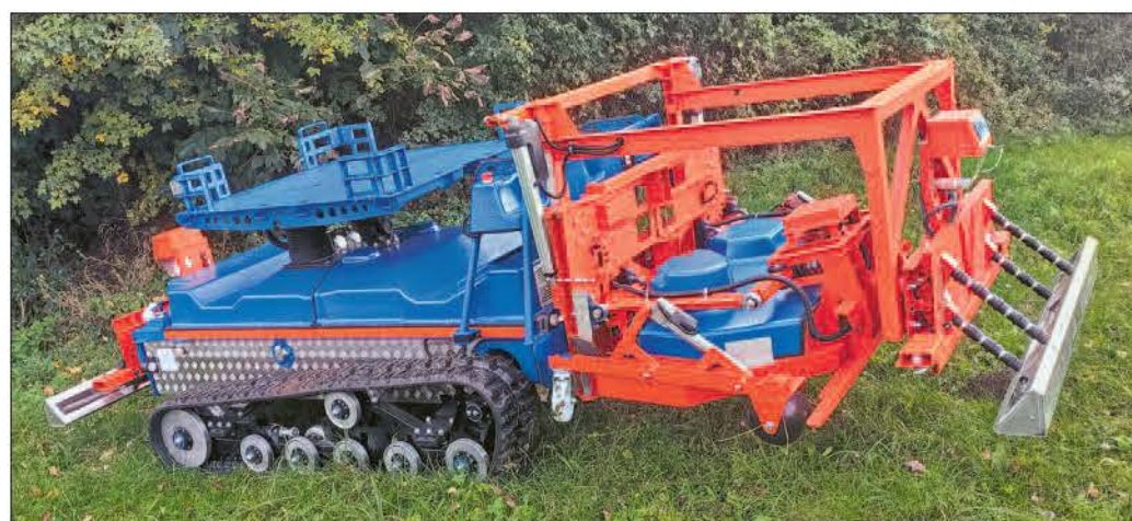
Slopehelper je sistem, sestavljen iz osnovne vozne platforme, pripetih priključkov in informacijskega sistema, ki omogoča avtonomno vožnjo (brez traktorista) in delo v vinogradu. (foto: Sasho Kuzmanovski)
