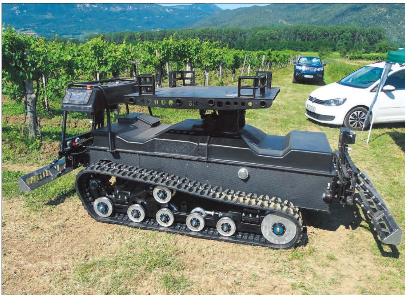
Slopehelper s pomočjo senzorjev in ustreznih računalniških algoritmov za vodenje popolnoma avtonomno vozi med dvema vrstama trte, izvaja delovne operacije in se obrača na koncu vrste. Po končanem delu »počaka« lastnika ob robu vinograda. (foto: Tomaž Poje)
