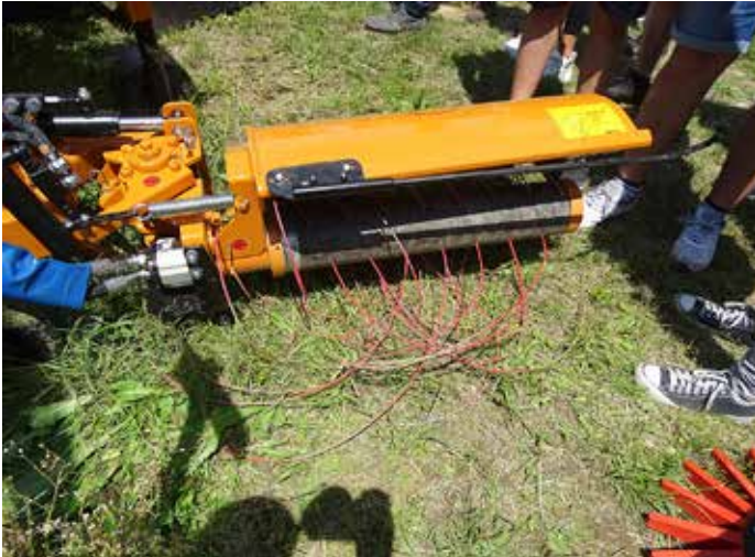
Obojestranski pletvenik Berti Ecosprint D 180/320 ima dolge nitke, tehta pa 771 kg. Pripet je bil na Landini Rex 4-110 F.
